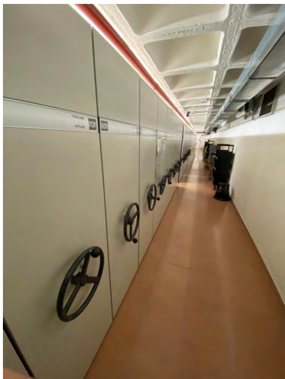
Рис. 1. До модернизации. Передвижные стеллажи с механическим приводом
