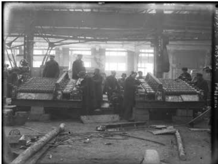
Грохоты «Гризли» в одном из цехов Уралмашзавода. Ноябрь 1932 г. Фото Н. К. Татарченко
